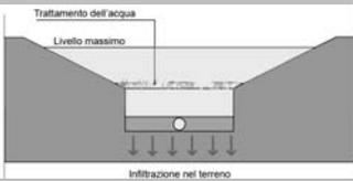
Vassoi a secco sono canali di vegetazione depresse, alla cui base viene previsto un elemento di filtrazione aggiuntivo ricoperto da uno strato di terra che aumenta la capacità di invaso e i benefici del trattamento.
