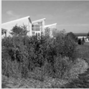
Le aree di bioritenzione sono zone depresse poco profonde costituite da substrati di terreno drenante ricoperti da fitta vegetazione. Svolgono un trattamento dell'acqua piovana che permette di rimuovere parte dell'inquinamento e riduce il volume dei deflussi d'acqua.
