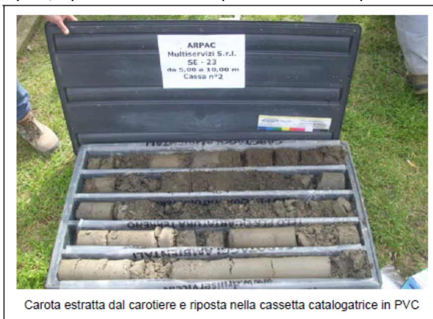
Figura 53. Carota estratta dal carotiere e riposta nella cassetta catalogatrice in PVC
