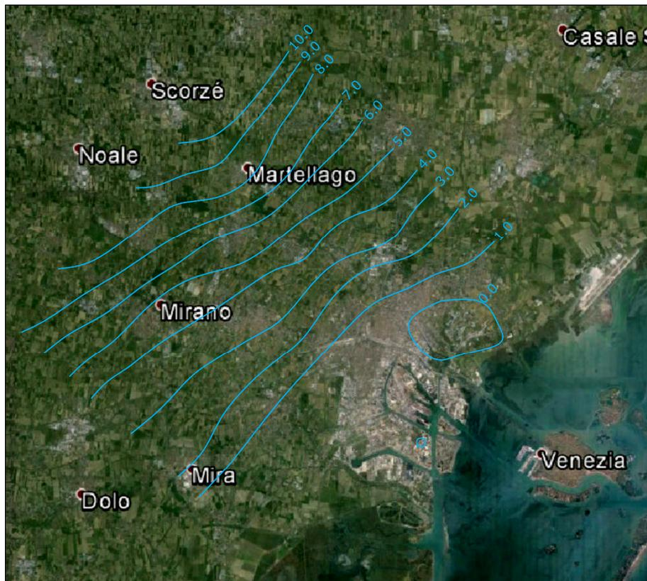
Figura 6.1.3: Ricostruzione piezometrica del 9 settembre 2013 (m s.l.m.)
