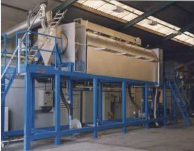
Impianto Di Riattivazione Termica
