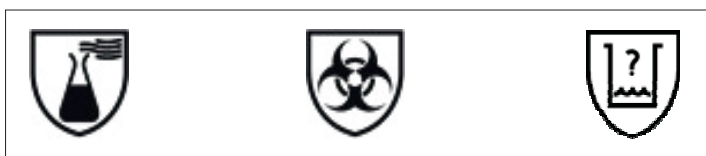
Figura 6: Pittogrammi relativi ai DPI per il rischio chimico; microbiologico; con livello di permeazione inferiore a 30 minuti (ad almeno 3 sostanze chimiche) ma conformi alla prova di penetrazione (riferito a DPI Cat. 1 o 2)
